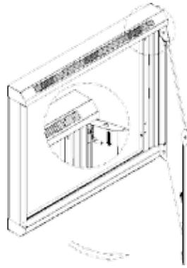
2. Öffnen Sie die Fronttür und entfernen Sie diese mittels des gefederten Scharniers vom Frontrahmen
