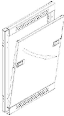
1. Entfernen Sie die Seitenwände aus den Seitenrahmen und legen diese separat ab.
