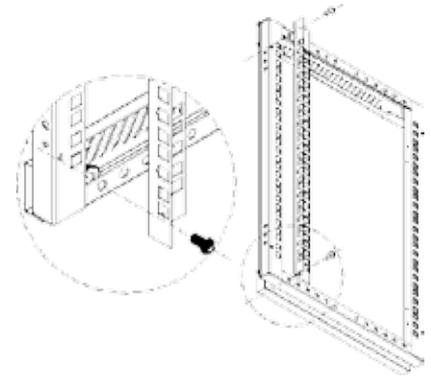
3. Montieren sie die 19" Profile mit je 2 Schrauben M5 x 8 oben und unten in den ersten Öffnungen der Seitenrahmen
