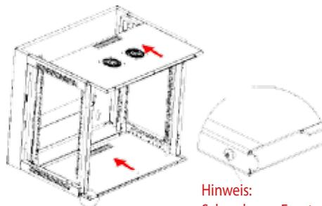
5. Montieren Sie Dach + Boden wie durch die Pfeile im Bild dargestellt. Hinweis: die seitlichen Schrauben zur Arretierung des Bodens zeigen zur Frontseite
