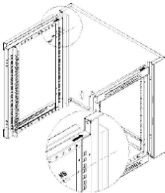
4. Befestigen Sie die Seitenrahmen mit je 2 Schrauben M6 x 12 in den vorgesehenen Nuten des rückseitigen Rahmens
